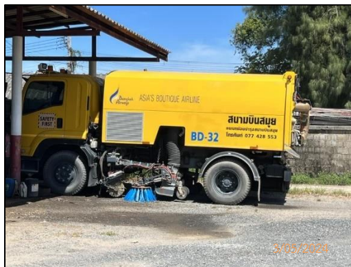
ภาพถ่ายที่ 2.2-8 รถดูดฝุ่นที่ใช้ทำความสะอาดทางวิ่ง-ทางขับ
